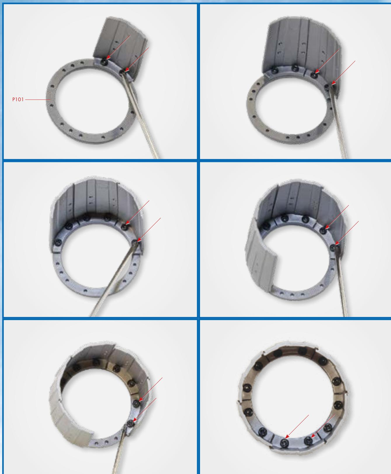
На этом этапе сборки вам потребуются все детали, полученные с этим номером. Последовательно закрепите на фланце форсажной камеры (P095) шесть внешних створок сопла (P101), как показано на снимках, используя для фиксации деталей винты FР. При закручивании винтов не прилагайте особых усилий, чтобы избежать повреждения деталей и винтов.
